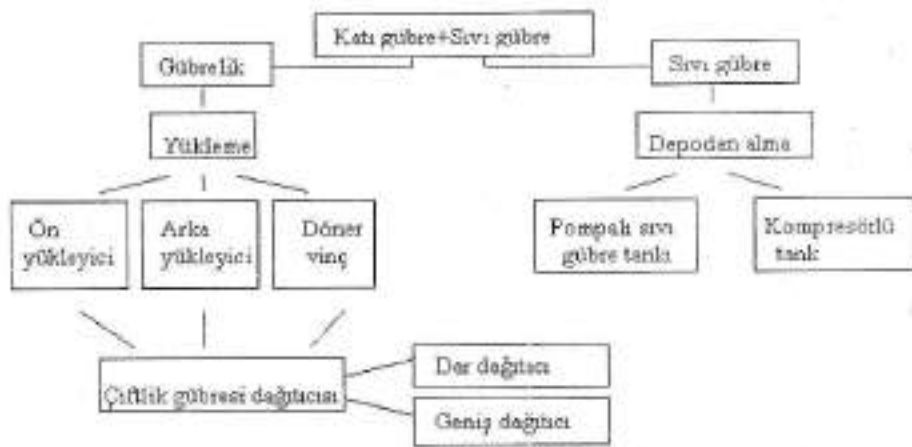
Şekil 4. Katı gübre mekanizasyonunda depolama ve tarlaya verme (Ayık 1985)
